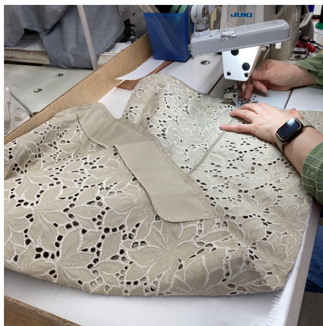
手作業による縫製工程
