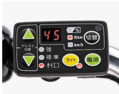
※（単位：1[km]、表示範囲：0～99）接続バッテリーの残量と選択している走行モードから、アシストできる走行距離の目安を表示します。ただし、バッテリーが劣化していたり、長い坂道を登ったり、ドライブユニットまたは、バッテリーに高い負荷が掛かっている等の場合、残リアシスト走行距離表示の誤差が大きくなる場合があります。
