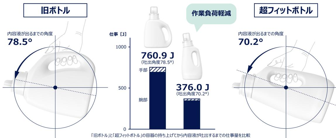
\*3 「旧ボトル」と「超フィットボトル」の容器を持ち上げてから内容液が吐出するまでの仕事量を比較
