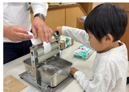
機械でシート絞って、含まれる洗浄液の量を確認
