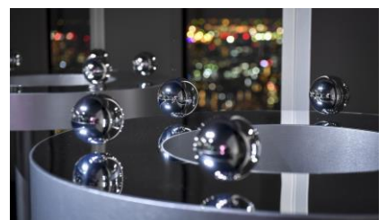
金属球を磁気浮上させ、景観を球体に写し撮りながら回転し続ける"lev (浮揚)"と"trope (回転)"からなる装置
