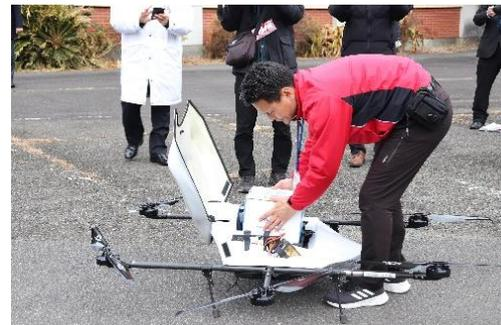
コープおおいたの荷物（生協組合員の定期配送の荷物）と中津急行が配送する同じ宛先の2つの荷物が混載された専用箱を物流専用ドローン AirTruck に搭載（宇目保健センター）
