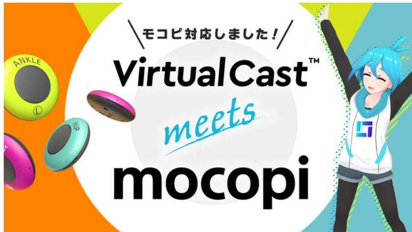
「mocopi」は、6つの小型センサー（直径約3cm、重さ各8g）を体に装着するだけで、どこでも手軽に、高精度かつリアルタイムなフルボディトラッキングができるモーションキャプチャーシステムです。今回のバーチャルキャスト対応開始により、ユーザーは、高価な機材や専用の設備を揃えずとも、全身の動きを含むアバター動画やモーションデータの制作を屋内外で手軽に行えるほか、モーション入力デバイスとして、アバターを自身の身体の動きと連携させて操作することができるようになります。また、PC版バーチャルキャストに加え、Quest版バーチャルキャスト（[https://www.oculus.com/experiences/quest/4174249979259348/?locale=ja\\_JP](https://www.oculus.com/experiences/quest/4174249979259348/?locale=ja_JP)）にも対応しており、パソコンを使わずに、複雑な設定をせずとも「Meta Quest2」と「mocopi」を直接連携してフルボディトラッキングが行えるようになります。
