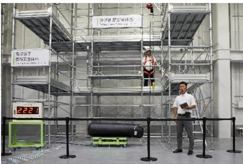
建設業界における「災害・事故の絶無」を実現するため、安全基準の研究、創造していくエリア。墜落や落下時の衝撃数値の可視化、映像コンテンツのバーチャル体感と実体感を用いた最先端の足場教育を提供します。
