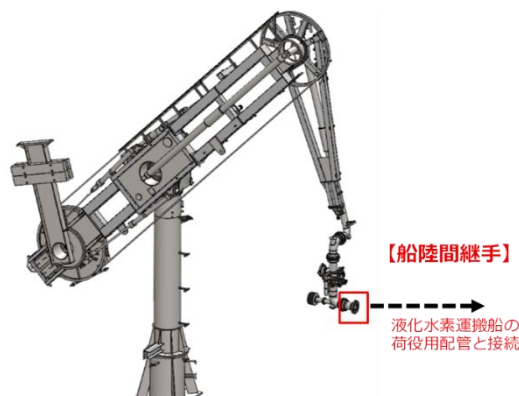
図 1：船陸間継手（液化水素運搬船の荷役用配管と液化水素基地の栈橋に設置されたマリンローディングアームを接続するためのフランジ型継手）
