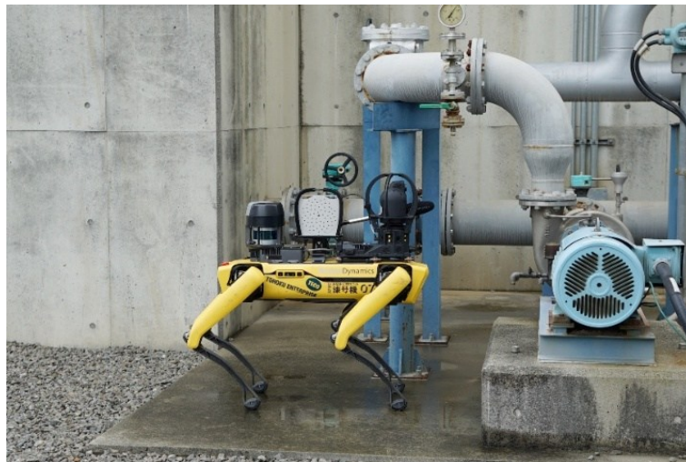
堺製油所で試験的に実施した四足歩行ロボットによる設備データ取得の様子
