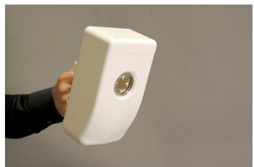
今回開発したワット級の深紫外 LED ハンディ照射機
