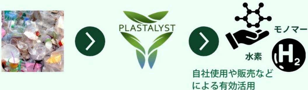
ボッシュ株式会社の工場等で発生した、廃棄プラスチックや動植物に由来する有機廃棄物を、AC Biode 株式会社が有する約 200 度の低温で分解する技術を用いて、水素やモノマー（プラスチックの最小単位）等に分解する実験を実施し、生成した水素等の成分分析を行う。この取組により、焼却処分する廃棄物等を削減するとともに、生成した水素等を化学技術メーカーへ販売することで、新たな資源循環モデルの確立を目指す。
