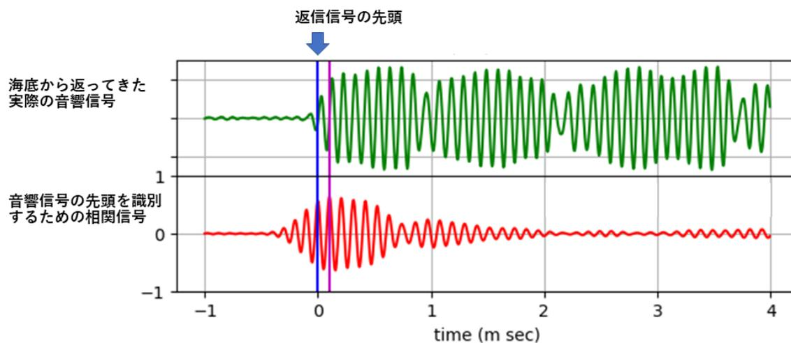
図2 海底から返ってきた音響信号(上段)とその識別のための相関処理の結果の信号(下段)
