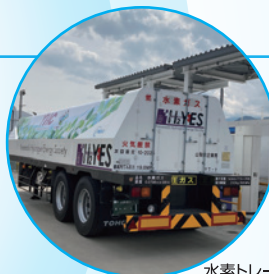
水素トレーラー
