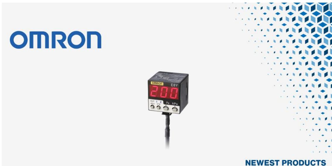
Omron の [E8Y-L](#) マイクロ圧力センサは、31mm × 30mm × 30mm のコンパクトな設計と、視認性に優れた赤色 LED 表示を特長としており、さまざまな使用環境やゾーンにおける圧力監視を可能にします。これにより、クリーンルーム内の圧力を一定に保つ用途や、ダクトやバルブを自動制御するアプリケーションなどに対応します。本センサは EN および UL の認証を取得しており、アナログ電流出力モデルや、ゼロ点調整機能を備えた Rc (PT) 1/8 の圧力ポートモデルを用意しています。また、センサのオン/オフ動作を行う圧力値をユーザーが任意に設定できる自動ティーチング機能を搭載しています。ゼロ点は任意の値に設定できるため、半導体ウエハ処理リニアターにおける圧力変動の管理、イオン注入工程での有機ガス流路の監視、パージガス漏れ検知などの安全システム用途において、圧力変化の把握を容易にします。さらに、前面パネルに配置された 4 つの操作ボタンにより、測定レ
