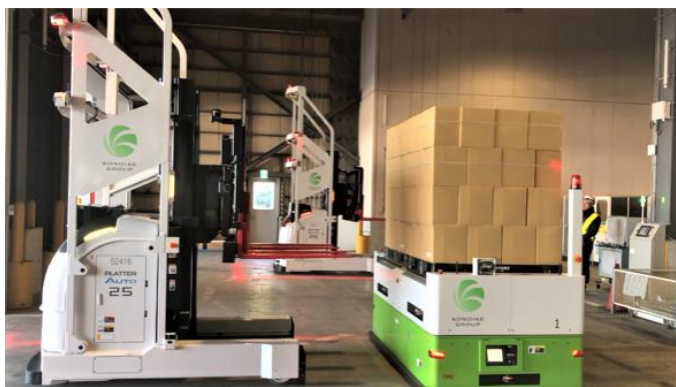
■ 倉庫にパレット積みされた荷物を AGF が搬出
