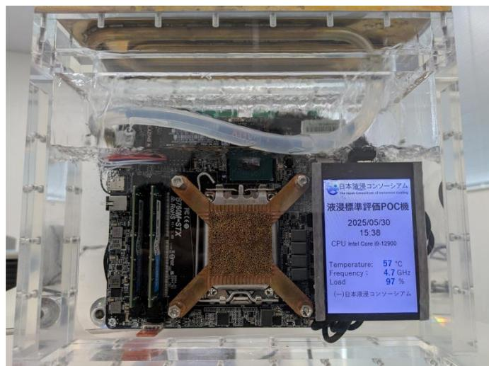
図4 開発した標準評価 POC 機
