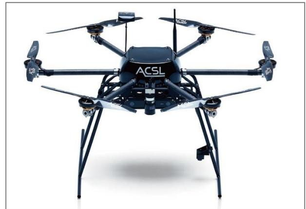
マグネシウム合金パイプを用いた溶接機体
