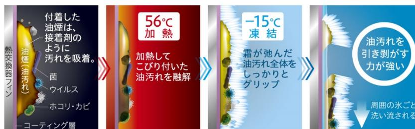
[図 1:「凍結洗浄ヒートプラス」の流れ(イメージ図)]
