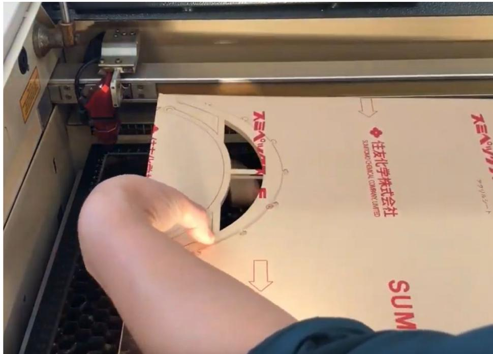
データを使用して、レーザー加工機で切り出しを行います。
