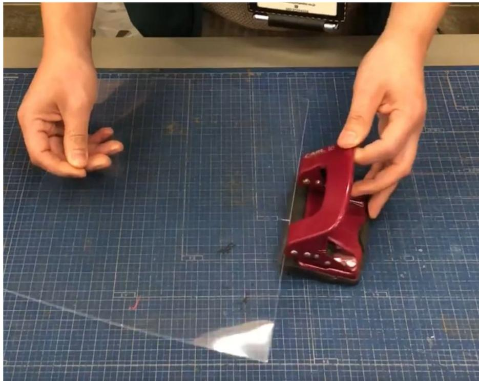
カットしたシールド素材に半分の折り目を軽くつけ、その印に合わせ、穴あけパンチで穴を開けていきます
