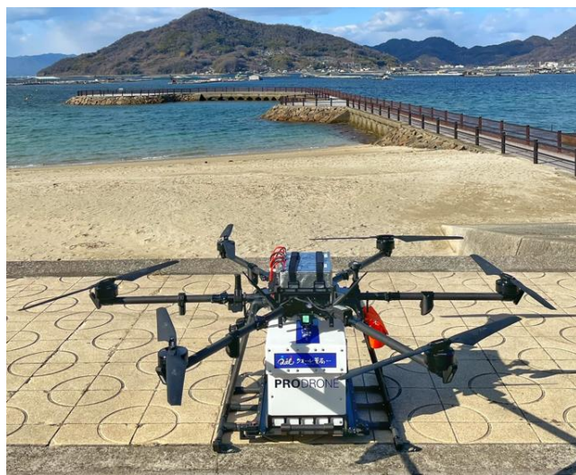
株式会社プロドローン PD6B-Type3 クオール特注のGPS追跡機能付き医薬品配送用ボックスを搭載
