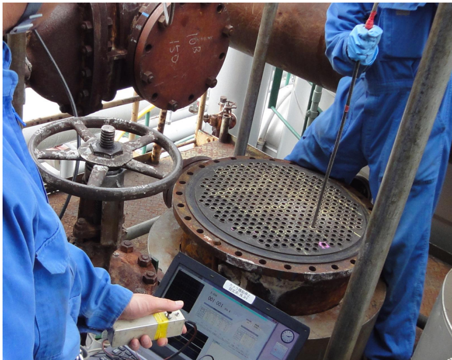
熱交換器伝熱管への FTECT 適用状況
