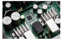
クプロセッサーが 1 チップ化されたことによって周辺回路がシンプルになり、より音質を優先した回路設計と部品の選定が可能になりました。電力を増幅する出力段やローパスフィルターにはデノン独自のノウハウを詰め込んだディスクリート回路を用い、サウンドマネージャーによる徹底したサウンドチューニングを施しています。
