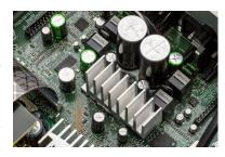
を超えたスピーカー駆動力を両立しています。また、音質に大きな影響を与えるローパスフィルター回路には、デノンカスタムの無酸素銅(OFC)線とマンガン亜鉛コアによるインダクターと Hi-Fi オーディオグレードの高音質フィルムコンデンサーを採用。温度特性に優れ、常に安定したパフォーマンスを発揮します。
