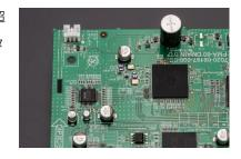
ートに合わせて切り替え、最適な周波数のクロックを供給。非整数倍の分周によるジッターを排除することにより、時間軸方向での波形の揺らぎを抑え、理想的な信号処理をおこないます。
