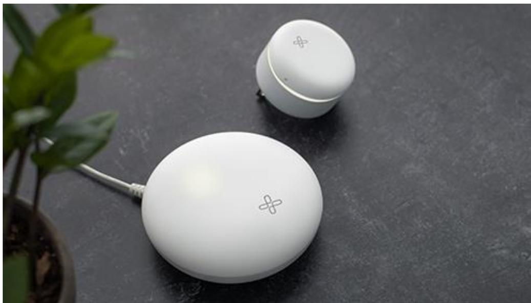
Hex Home ホームセキュリティシステムは、Hex Command (据え置き型の親機)、Hex Sense (コンセントに直接さす子機) という2種類のデバイスを設置し、Wi-Fi 電波によりユーザーの室内を監視するサービスです。人が動くとWi-Fi電波の反射が変化するので、Hex Home は、この電波変化を計測し、何か有意な動きが検出されるとユーザーに通知するという仕組みです。ユーザーは、Hex アプリを通じて室内での動きをリアルタイムで(かつ過去履歴も)確認でき、サイレンを鳴らしたり通知をカスタマイズしたりできます。
