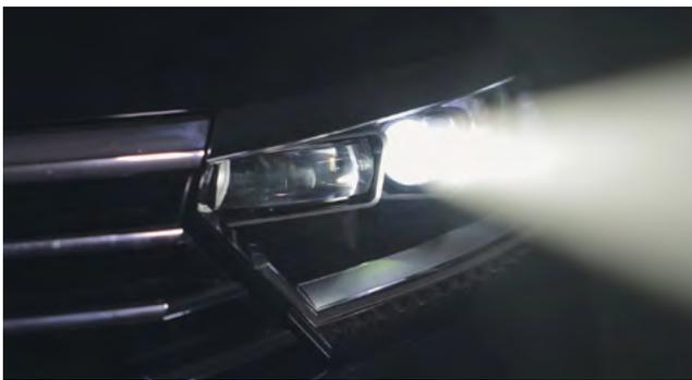
自動運転車が路上に出現することを想定し、ヴァレオはすでに自動車メーカー各社へValeo PictureBeam Monolithicを提案しています。その狙いは、道路交通の安全性の向上と同時に、カスタマイズと快適性のための新たな機能を提供することです。このイノベーションにおいて、光ビームのピクセルはチップの光源から直接作り出されます。そのため、このモジュールは市場に存在する他のHDライティングシステムよりも小型軽量で、車への搭載も容易です。この新しいタイプのLEDチップは数千ピクセルレベルの精細度を実現します。ヴァレオが設計したエレクトロニクスシステムにより、ピクセルごとのオンオフの切り替えと、自由に調整することが可能です。
