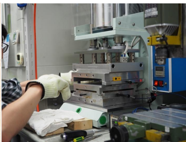
プラスチックは細かく粉砕し機械で圧力をかけて成型する
