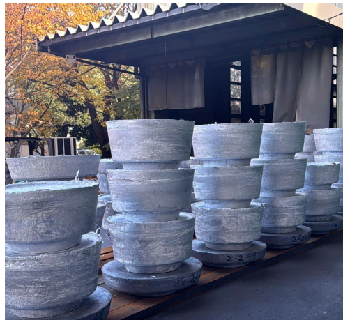
左：液体状になったアルミを型枠へ流し込む様子 右：凝固したベースメタルを冷ます様子
