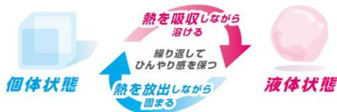
PCM（潜熱蓄熱材）とは ※PCM/Phase・Change・Material
