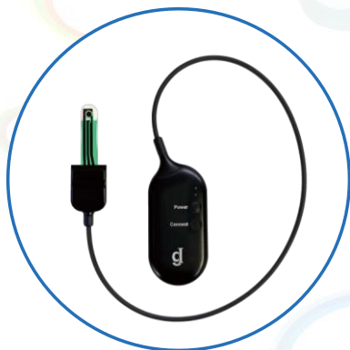
デバイス本体（無線通信） 測定用チップ（1回ごとに交換）
