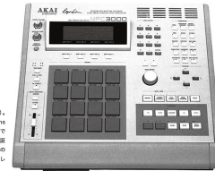
アカイMPC3000(1994年)。MPC2000とは、Line Dromeの発売後22年ぶりに2016年1987年に最初のMPC2000誕生。MPC3000ではCDレコーディング16ビット/44.1kHzでデジタルサンプリングを実現していた。
