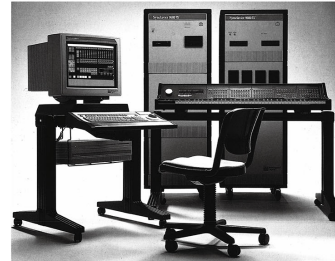
ニュー・イングランド・デジタルのシンクラヴィア、R4015で、ルーンバー、サンプラーのみならず、ハードディスクレコーディングやミキシングなどの機能を備えた。現在のDAW(デジタルオーディオワークステーション)の発展形。CD044.1M48と100kHzでサンプリングが可能な機種だった。
