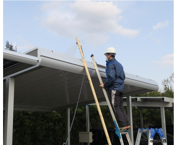
※安心な止水構造(放水試験にて止水確認)
