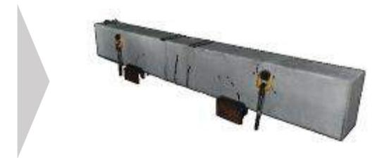
損傷部まで復元した構造物の高精度3次元モデル
