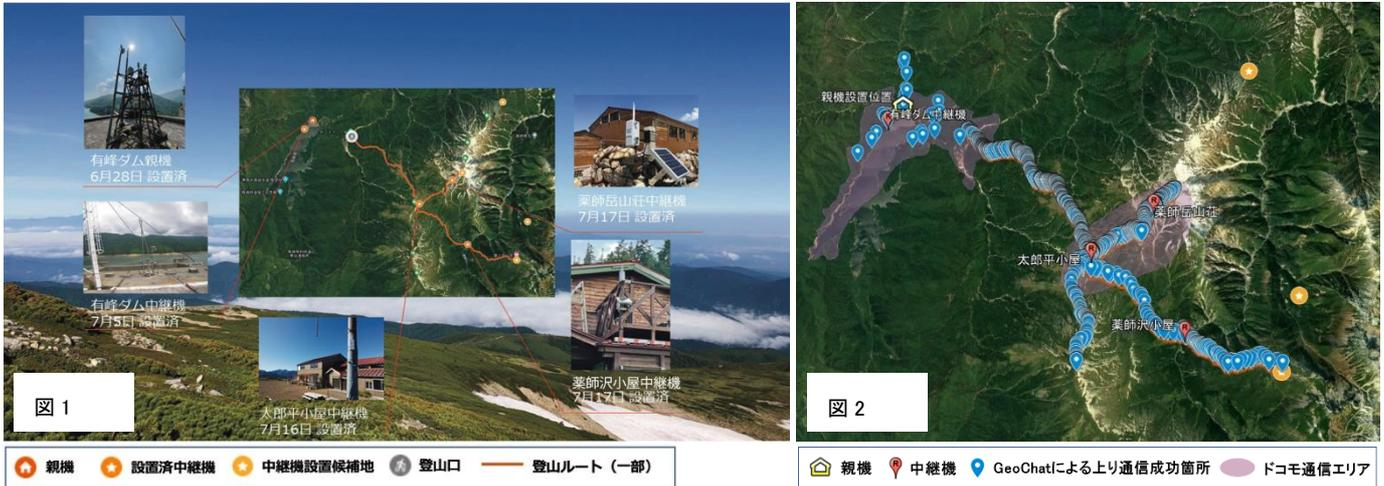
株式会社フォレストシー(本社:東京都江東区、代表取締役 時田義明)は、北陸電力株式会社、国立大学法人富山大学、五十嶋商事有限会社などの北アルプスの山小屋と共同で2021年6月から開始した北アルプスIoT通信インフラ構築実証試験の第一段階として、2021年6月28日及び7月5日に北陸電力株式会社の有峰ダムにLPWA※を活用した通信インフラ機器の親機・中継機を設置しました。その後7月16日～18日に山小屋3箇所(太郎平小屋、薬師沢小屋、薬師岳山荘)に中継機を増設し、通信端末を使った登山道での広域通信テストに成功しました。
